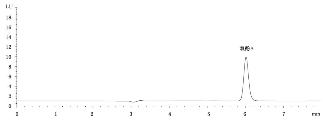
图 A.2 3%(质量浓度)乙酸溶液中双酚 A(0.6 mg/L)标准色谱图
